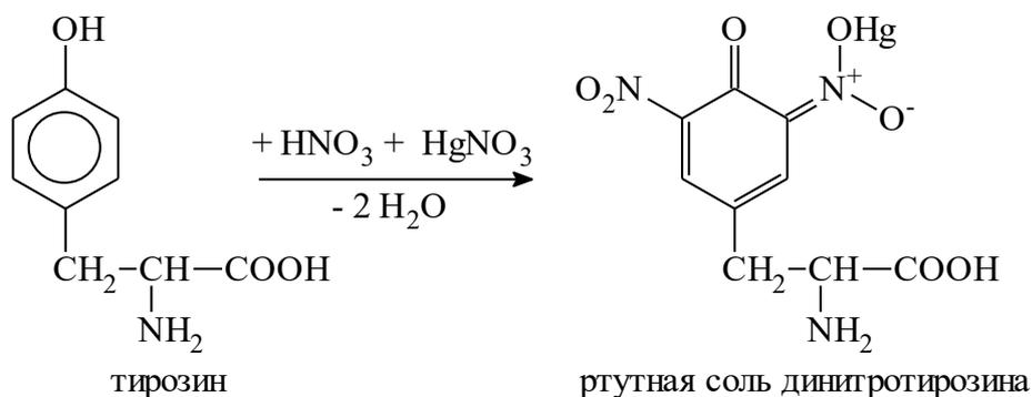
Ход работы: К раствору белка 1-2 мл прилить 5-6 капель реактива Миллона. Осадок белка при нагревании окрашивается в красно-коричневый цвет, вследствие образования ртутной соли нитрозина. Следует избегать прибавления избытка реактива Миллона, поскольку он содержит азотную кислоту, которая при взаимодействии с белком может дать желтое окрашивание (ксантопротеиновую реакцию), маскирующее реакцию Миллона.
